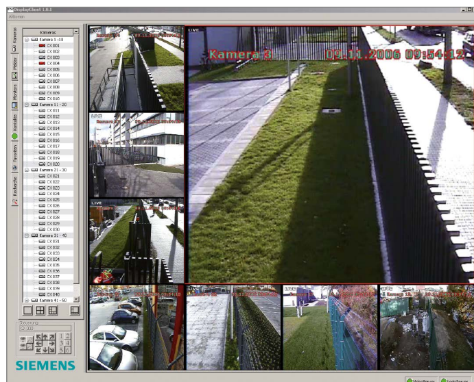
Abbildung 11: Security Display Client (SDC) zur Darstellung von mehreren Videobildern und variabler Bildschirmaufteilung
