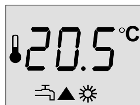
Anzeige im Normalbetrieb Heizung EIN WW-Bereitung EIN
