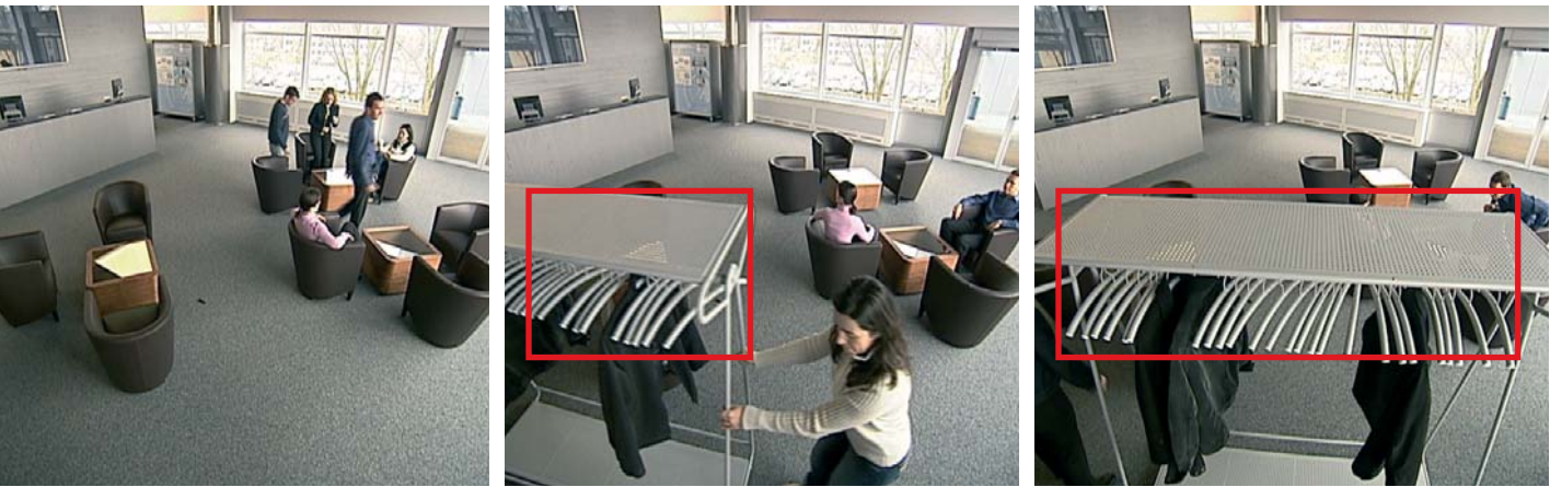
Eine Beeinträchtigung des Sichtfeldes wird detektiert.
