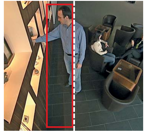
Eyetec alarmiert, sobald eine Bewegung im geschützten Bereich detektiert wird.
